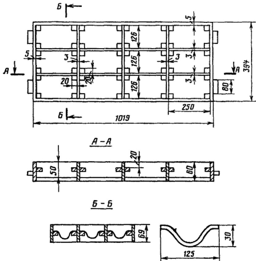
Рис. 2. Конструкция кассеты с формами
