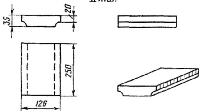
Рис. 1. Типы сборных асфальтобетонных блоков
