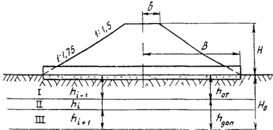
Рис. 3. Схема к расчету осадок труб на опаивающих грунтах
