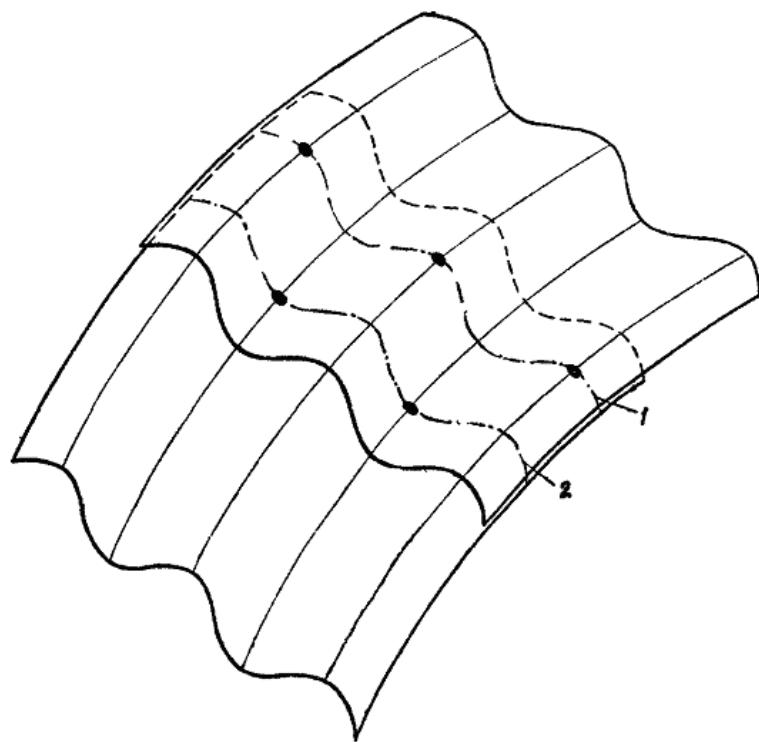
Рис. 8. Схема размещения болтов продольного стыка:
