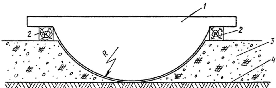
Рис. 6. Схема установки шаблона для вырезки грунтового ложа в нулевом слое:
