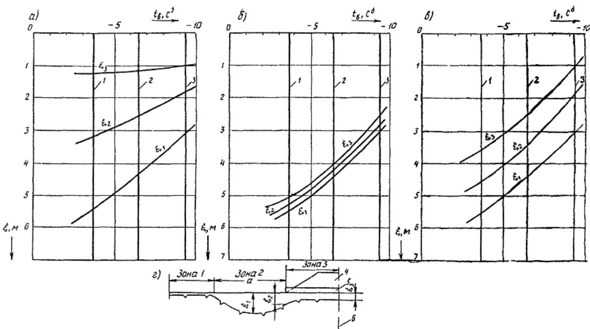
Графики для определения расчетной глубины пропаивания грунтов ( $\xi_1$ ,  $\xi_2$ ,  $\xi_3$ ) в зависимости от среднегодовой температуры  $t_b$  воздуха  $\xi = f(t_b)$ :
