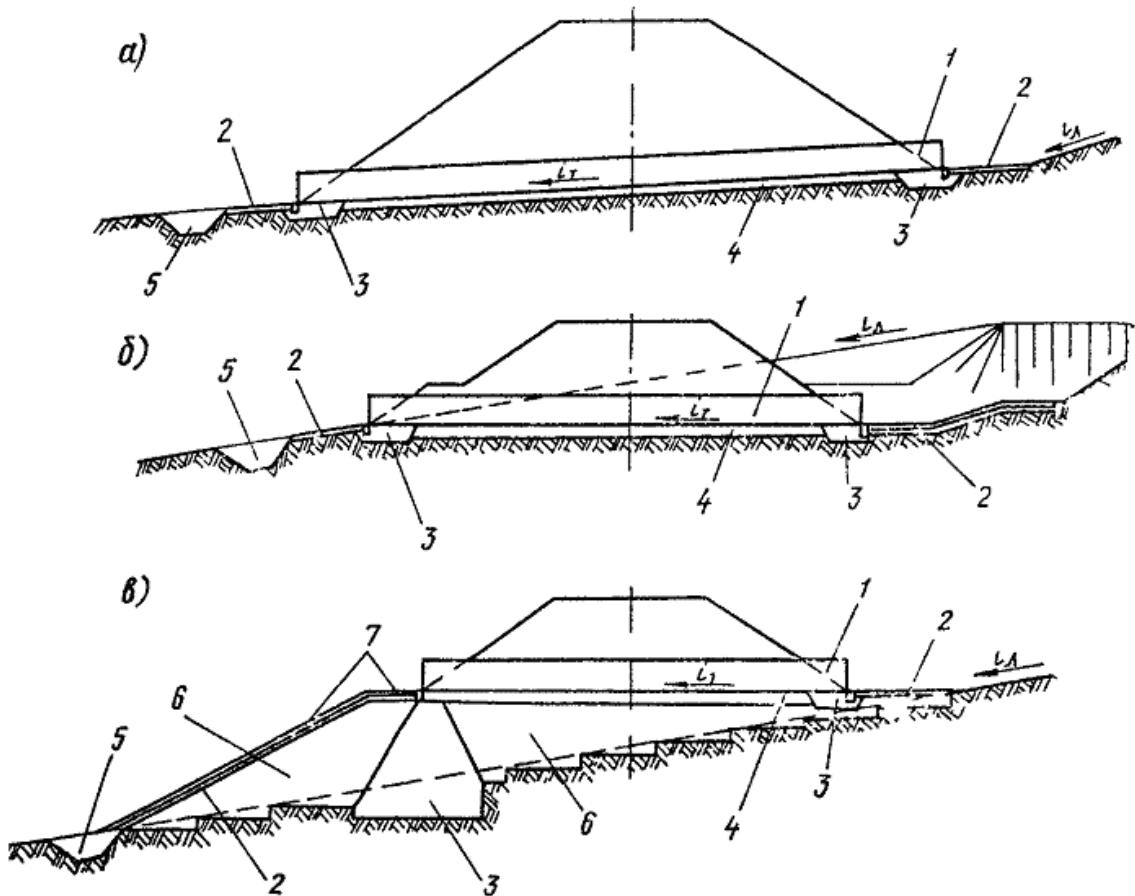
Рис. 2. Схемы размещения труб на косогорах:
