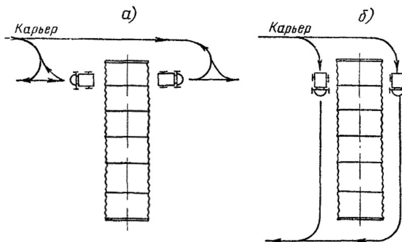
Рис. 12. Схемы движения автосамосвалов в процессе отсыпки грунта
