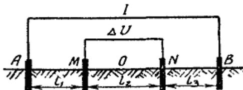
Схема для определения удельного сопротивления грунта
