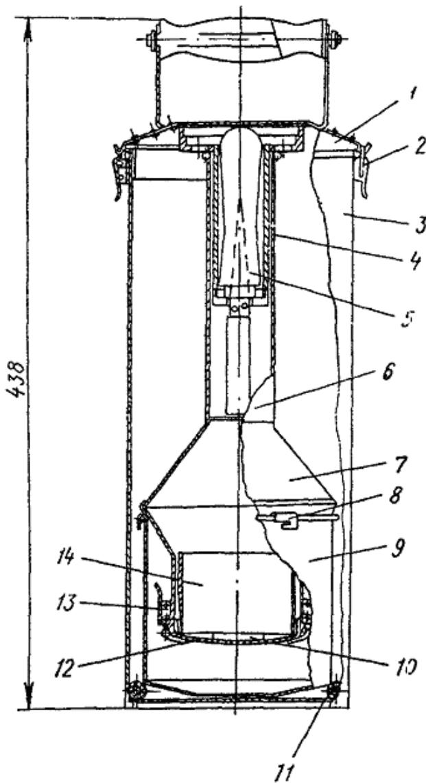
Рис. 1. Схема плотномера-влагомера Н. П. Ковалева:
