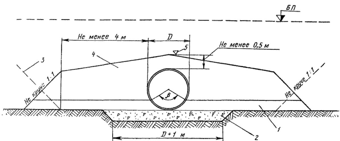
Рис. 4. Конструкция грунтовой призмы металлических гофрированных труб:
