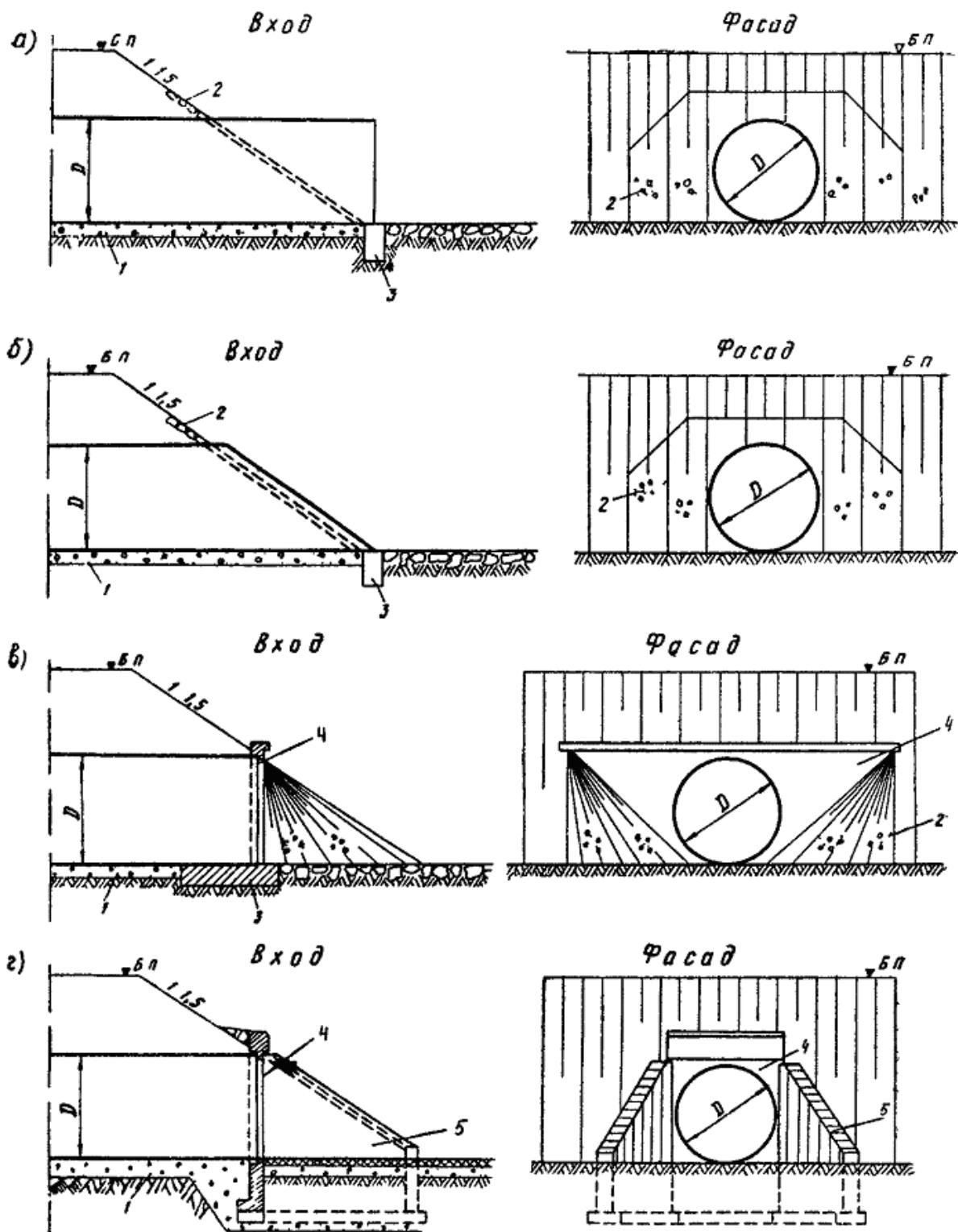
Рис. 1. Схемы конструкций труб с верховой стороны насыпи:
